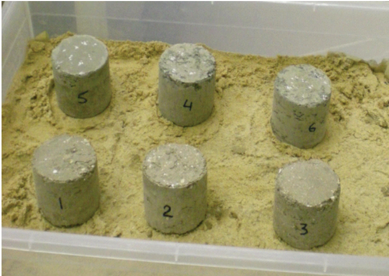
Образцы 5,6 после водонасыщения
