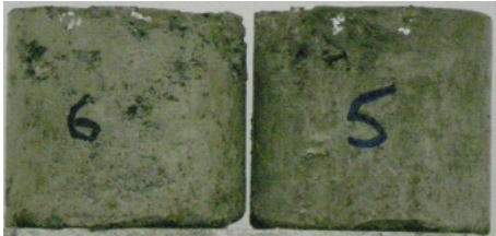
Образцы 5,6 после водонасыщения
