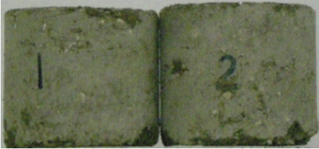
Образцы 1,2 после 5-ти циклов
