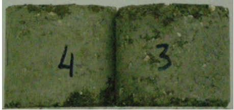
Образцы 3,4 после 15-ти циклов
